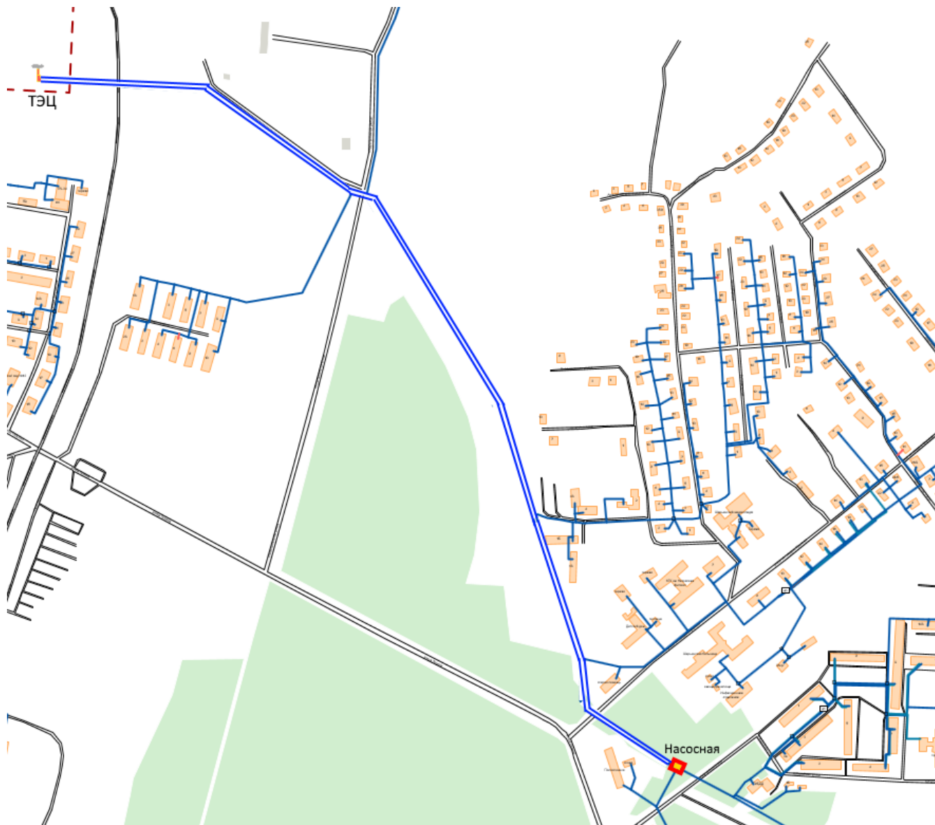
Рисунок 6.5.1 - Схема тепловых сетей от ТЭЦ после прокладки новых тепломагистралей
