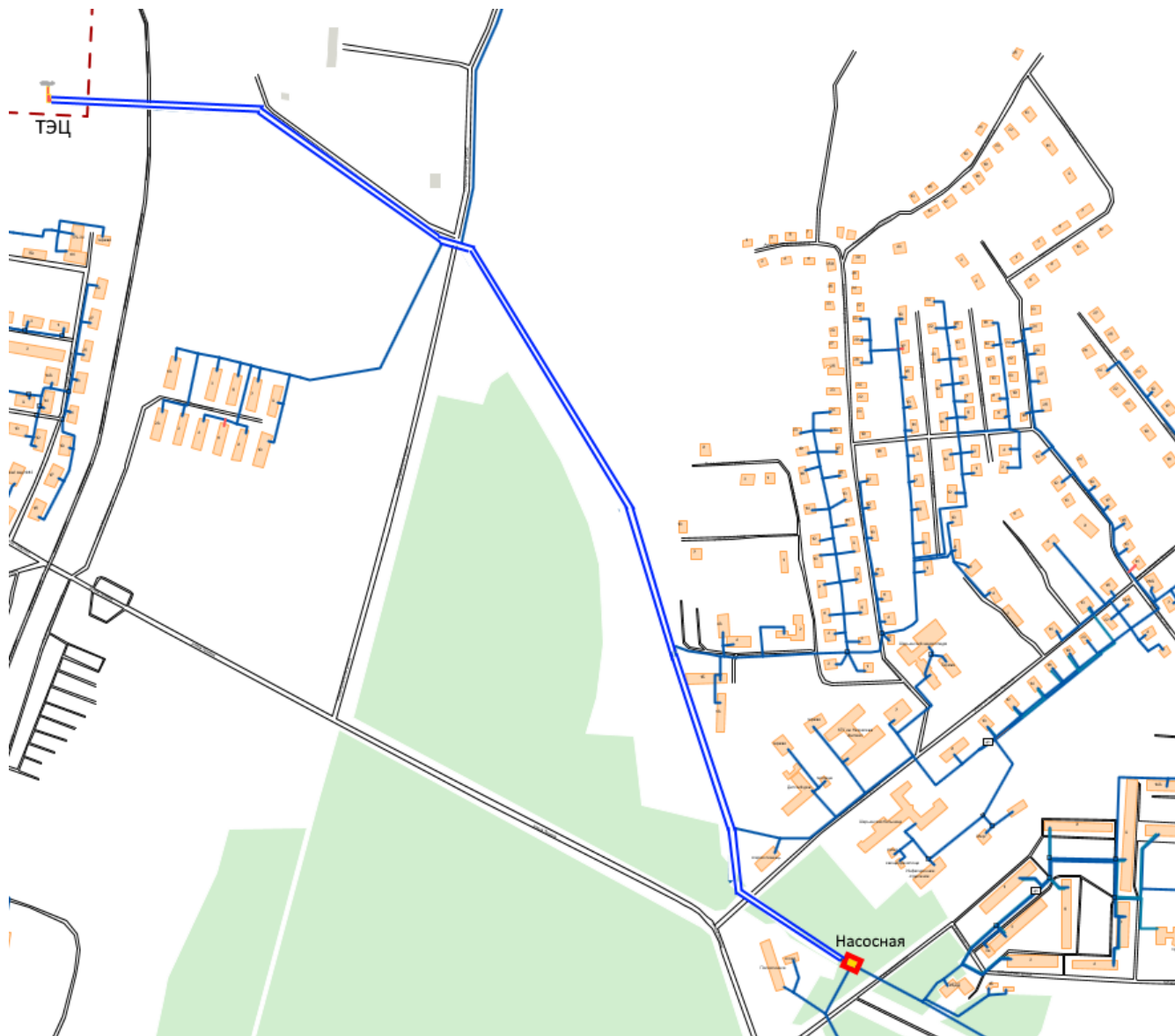
Рисунок 6.5.1 - Схема тепловых сетей от ТЭЦ до города Шарья после прокладки новых тепломагистралей
